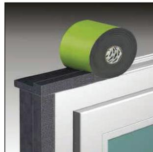
Bild 3: TP321 auf den Rahmen kleben – Seite mit dem grauem Aufdruck nach Innen. An den Ecken das Band überstehen lassen.
