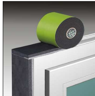
Bild 3: TP652 auf den Rahmen kleben - Seite mit dem grauen Aufdruck nach Innen. An den Ecken überstehen lassen.
